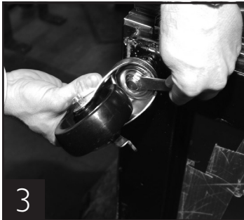
3 Die Rolle mit dem beigelegten Werkzeug festziehen.
