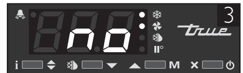
Image 3 : Si « non » apparaît à l'écran, le contrôleur est déverrouillé.
