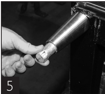
5 L'extrémité du pied est réglable pour une mise à niveau facile.
