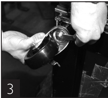
3 Utilisez l'outil fourni pour serrer la roulette en place.
